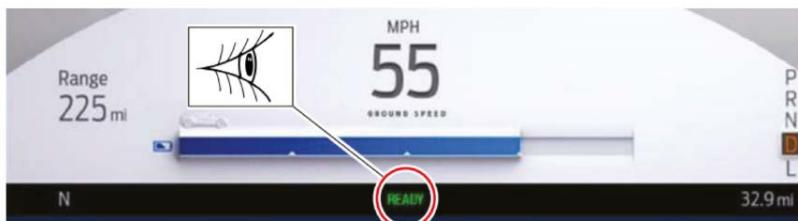
Contrôler si le système haute tension est alimenté.
